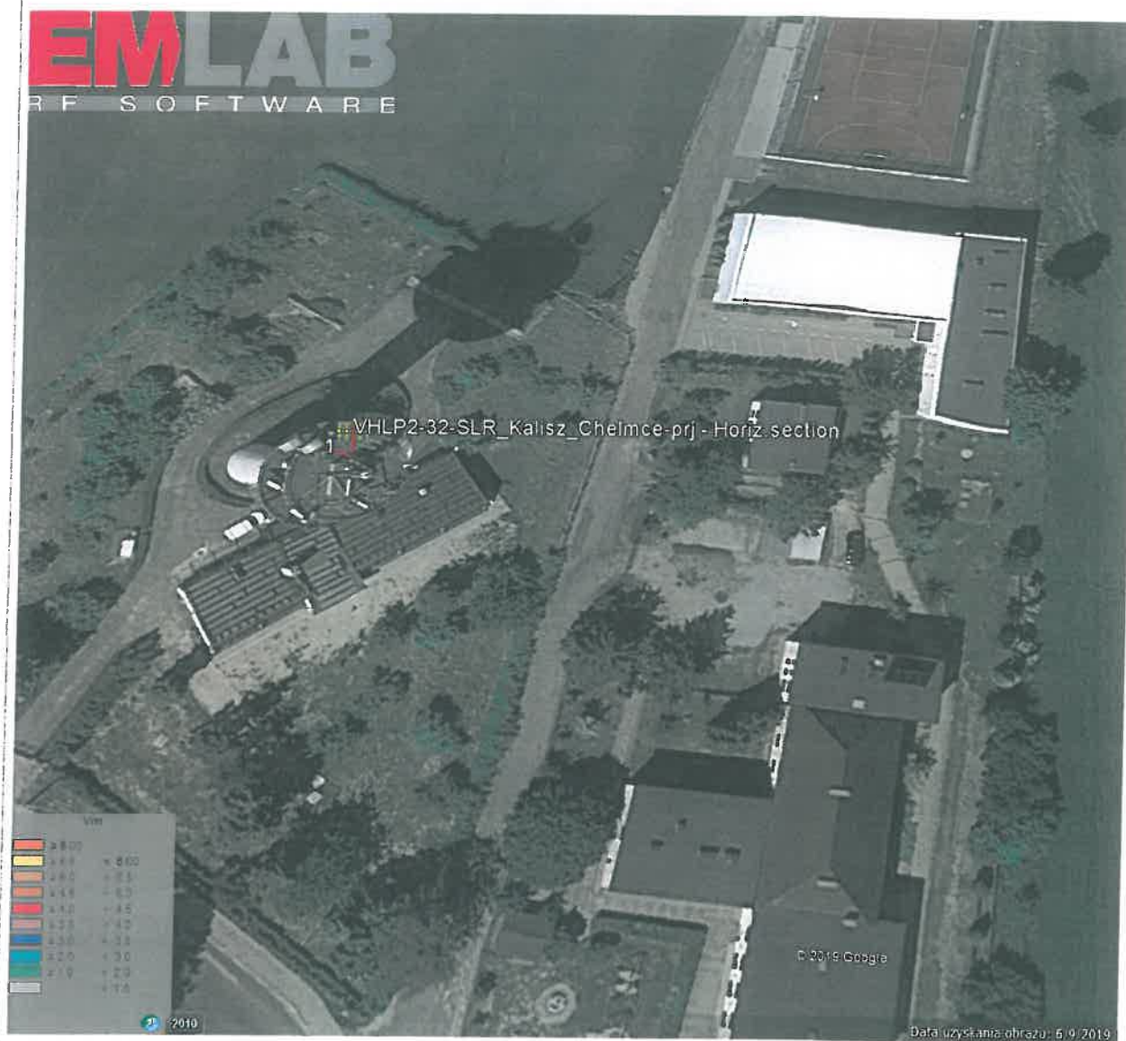
Rys. 2. Rzut poziomy rozkładu pola elektromagnetycznego anteny nowo projektowanej linii radiowej w otoczeniu SLR Kalisz Chełmce przewidzianej do zainstalowania na wysokości 54 m nad poziomem terenu.
