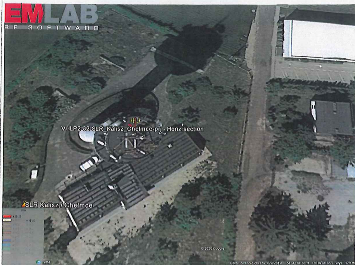
Rys. 2. Rzut poziomy rozkładu pola elektromagnetycznego anteny nowo projektowanej linii radiowej w otoczeniu SLR Kalisz Chelmce przewidzianej do zainstalowania na wysokości 54 m nad poziomem terenu.
